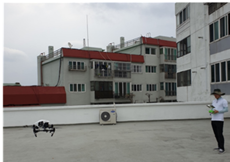
그림 5. 열적외 영상촬영에 사용한 장비(Inspire 1 pro) 및 촬영 장면
