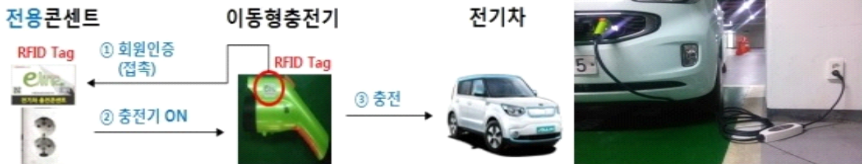
<그림 9> 이동형충전기의 충전방법
