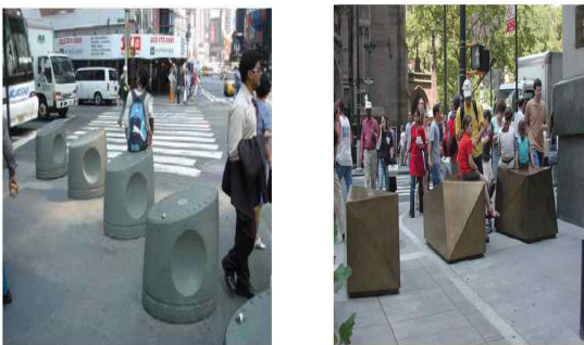
<그림 4> 부지경계에 설치되어 차량을 이용한 폭발물 테러를 예방하는 동시에 시민들의 편의를 증진시킬 수 있는 블라드 디자인 사례
