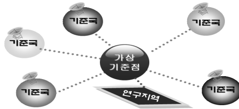
<그림 5> VRS(Virtual Reference System) RTK시스템
