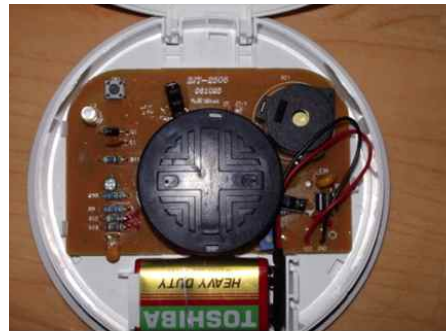
<그림 1> 단독경보형감지기 외관 및 내부 부품
