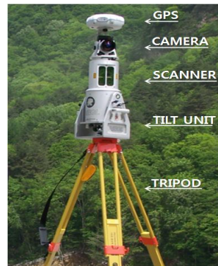
<그림 2> 지상 LIDAR 스캐너의 구성
