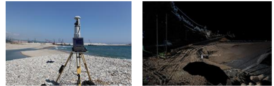
<그림 5> 가곡천 리이다 측정 전경 및 스캔결과
