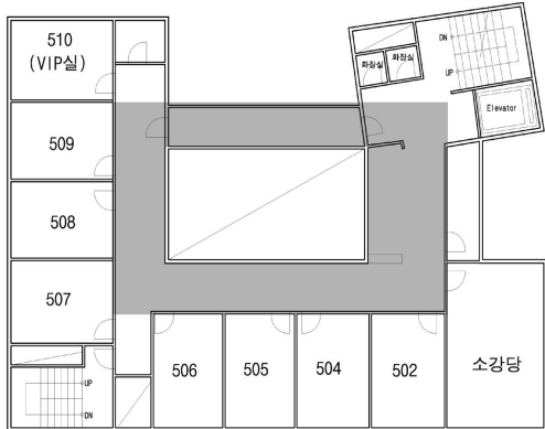
그림 17. 口자형-5층 병동공간: 연결다리가 내부의 복도와 연계, 설치됨으로써, 口자 형태의 동선구성을 가능하게 하였다.
