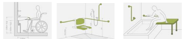
휠체어사용자의 세면대 이용 : 세면대 하부공간 확보 샤워공간 접의식의자, 수평손잡이, 높낮이 조절형 샤워기 설치 휠체어 사용자의 욕조이용 : 욕조의 높이, 휠체어 및 이동의자 높이 (40-45cm)
