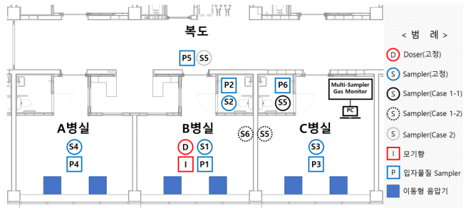
[그림 3] 감염원 모사 확산실험용 측정기기 설치 위치
