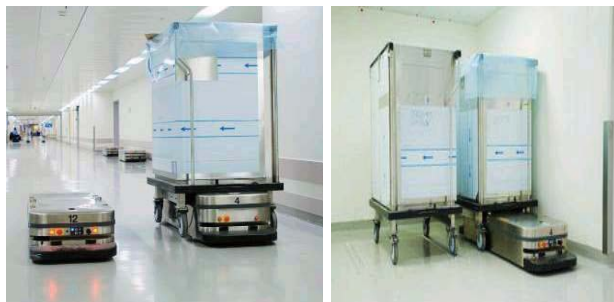
[그림 10] AGV(Automatic Guided Vehicle)의 물품운반 사진
