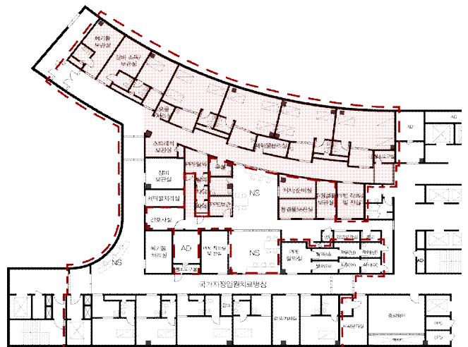
[그림 10] KS병원 변경 후 도면(점선은 음압, 음영은 공사부분)
