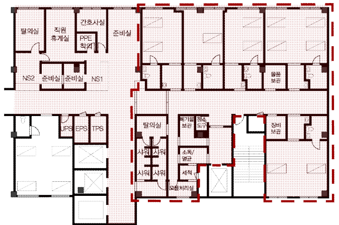
[그림 2] G병원 변경 후 도면(점선은 음압, 음영은 공사부분)
