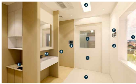
<전실> ①창 ②시계(환자 시각각 보완) ③응급 호출벨(의료진) ④간접조명 ⑤관찰창 ⑥문(인터록구조) ⑦바닥재(탄성) ⑧콘트롤 모니터(전기, 온도, 차압 등) ⑨보호구 착용 공간 ⑩세면대 ⑪폐기물통
