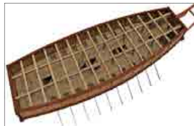
<그림 15> 판옥선 3D모델링으로 나타난 노꾼의 위치 노의 위치
