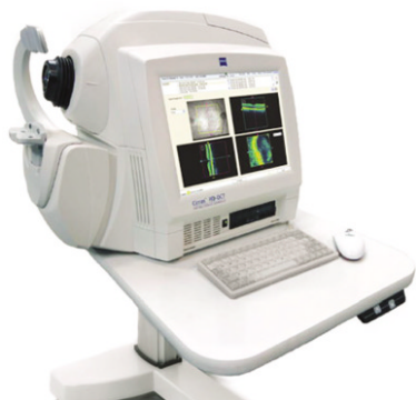
그림 15. 안과용 OCT 기기(좌) 개발단계에 있는 치과용 OCT로 본 치아 소구치(우). 치아를 자르지 않고 외부에서 광을 조사하여도 내부의 우식이나 결함을 관찰할 수 있는 비침습성 진단기기이다.
