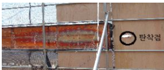
그림 9. 적외선열상표적 후면 및 유도탄 관통사진 Fig.9 Backside Image of ITT after Evaluation Test
