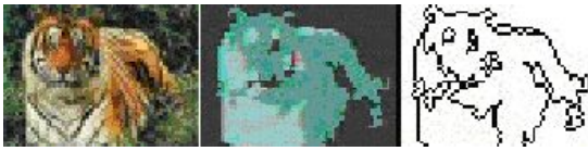
그림 2. 원영상의 1/16의 계층 영상, 분할, 윤곽선 Fig. 2 Hierarchical image in 1/16 of the original image, segmentation, and outline
