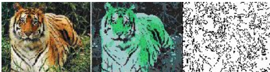
그림 3. 원영상의 1/4의 계층 영상, 분할, 윤곽선 Fig. 3 Hierarchical image in 1/4 of the original image, segmentation, and outline
