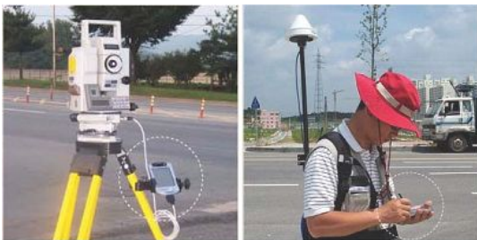
그림 1. 토털스테이션, GPS 유선통신모듈 사용 예 Fig 1. An Example of Communication Module using Total Station & GPS
