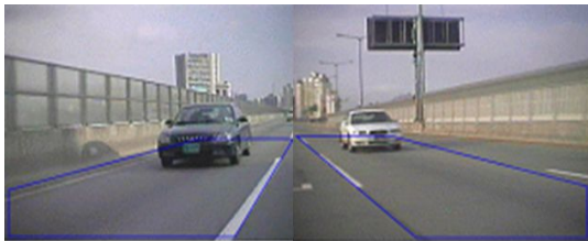
그림 7. 측후방 차량 검색 영역 Fig 7. Search area for vehicle detection
