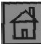
그림 13. 정사각형 형태로 변환된 마커 영상 Fig 13. Marker image warped into an exact square
