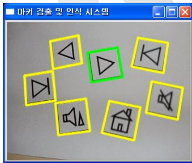
그림 19. 다중 마커 검출 예 Fig 19. Multiple marker detection
