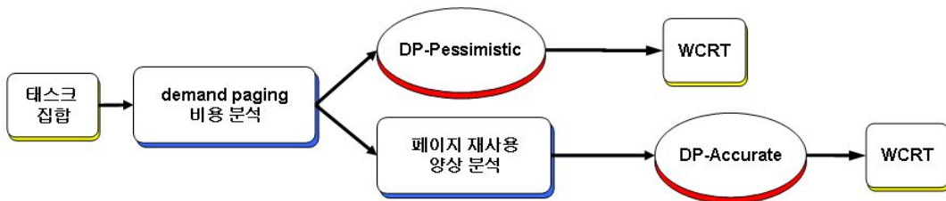
그림 2. demand paging 환경에서의 WCRT 전체 분석 과정 Fig. 2. WCRT analysis for demand paging overview
