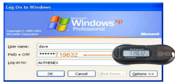
그림 2. Token OTP를 이용한 인증 예 Fig. 2. The authentication that used token OTP
