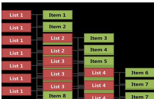
그림 7. SECS-II 메시지의 구조 Fig 7. Structure of SECS-II Message
