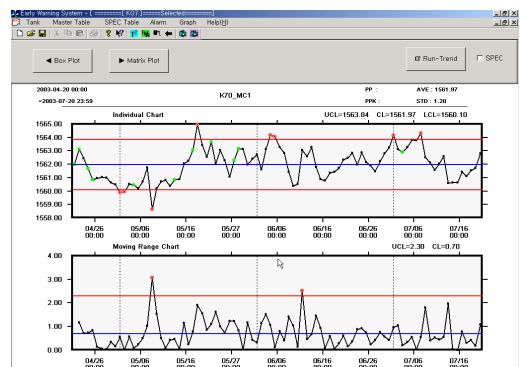
그림 5. I-MR 관리도 Fig 5. I-MR control chart
