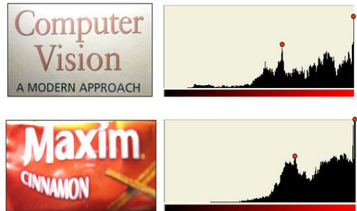
그림 5. 편광 영상의 Red 히스토그램 분포 및 2개의 pick Fig.5 Histogram distribution of polarized image and position of picks
