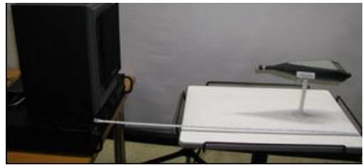
그림 3. 스피커의 음향센터 측정 장치 Fig. 3. A measure of speaker's acoustic center
