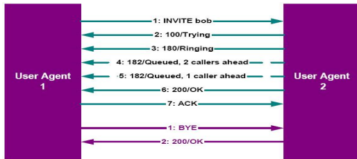
그림 2. SIP INVITE 메시지 요청과 응답 Fig. 2 SIP INVITE Message Request and Response
