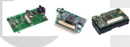
그림 4. MICA 하드웨어 플랫폼 Fig. 4. MICA Hardware Platform: MIB510CA Interface Board(left), MTS300 Sensor Board(center), MPR2400 Motel(right)
