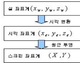
그림 7. 시각변환과 원근투영 절차 Fig 7. Process of viewing transformation and perspective projection
