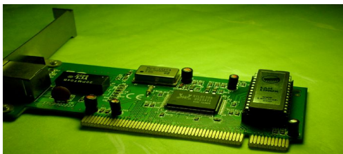
그림 4. 부트롬을 장착한 랜카드 Fig 4. Ethernet Card for BootRom to be fixed
