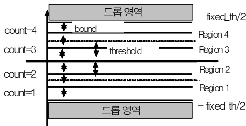
그림 3. 패킷 폐기 영역 Fig. 3 Packet Dropping threshold
