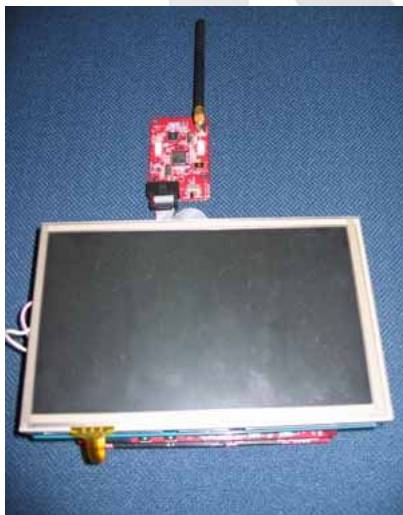
그림 6 베이스노드와 게이트웨이 연결 fig 6. Base node and gateway connection
