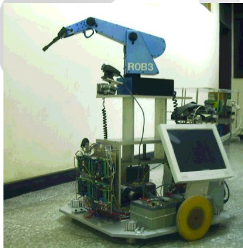
그림 1. 이동매니퓰레이터 PURL-II Fig. 1. mobile manipulator PURL-II
