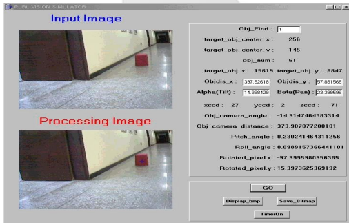
그림 7. 물체 위치 추정( \alpha=14.4^\circ , \beta=24.3^\circ ) Fig. 7. Estimation of object position( \alpha=14.4^\circ , \beta=24.3^\circ )
