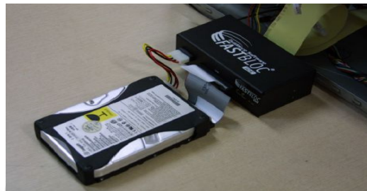
그림 2. 쓰기방지장치가 부착된 디스크 Fig. 2 Hard Disk Equipped with Anti-writing Device
