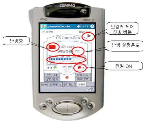
그림 8. PDA 제어 인터페이스 Fig 8. PDA Control Interface
