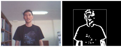
(a) 입력 영상 (b) ROI 영상 그림 4. 입력 영상과 ROI 선정 영상 Fig 4. Input image and ROI image
