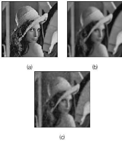
그림 2. (a) 원영상 (b) 가우시안 잡음 G10이 추가된 잡음영상 (c) 임펄스 잡음 I0.1이 추가된 영상
