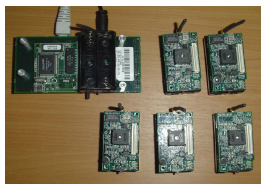
그림 4. RF 센서 노드 Fig. 4. RF Sensor Node
