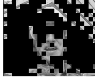
그림 6(c) DCT 계수를 이용한 객체검출 Fig. 6(c) Object extraction based on DCT coefficients
