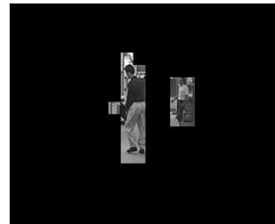
그림 4(b) DCT 계수를 이용한 객체검출 Fig. 4(b) Object extraction based on DCT coefficients
