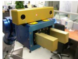
그림 1. 3차원 공간인식을 위한 스테레오 카메라 Fig 1. Stereo camera for 3D space recognition
