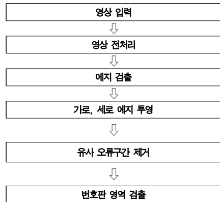
그림1. 제안된 알고리즘의 블럭도 Fig. 1 Block diagram for the proposed algorithm
