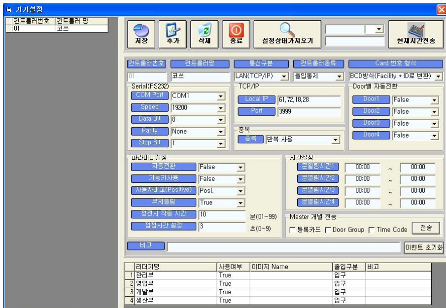
그림 10 출입 통제용 시스템의 운용 화면 Fig. 10 Operation Screen of Access Control System
