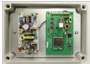
그림 8 센서 네트워킹 장치를 케이스에 조립 Fig. 8 Assemble on Case for Sensor Networking Device
