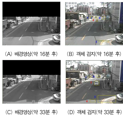
그림 6. 객체 배제 평균 누적 배경모델링 방법 Fig 6. average accumulation method of object exclusion
