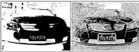
그림 3. 하나의 임계값 영상(좌)과 블록 이진화 영상(우) Fig. 3 A Binarized Image by Single Threshold Value(left) and a Binarized Image by Block Binarization(right)
