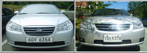
그림 2. 유럽형 번호판(좌)과 기존 크기 번호판(우) Fig. 2 License Plate of European Style(left) and License Plate of Conventional Size(right)
