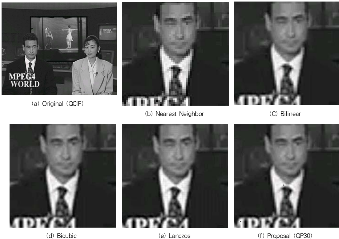
그림 9. 보간법에 따른 화질 비교 ('News', QCIF, 200%) Fig. 9. Image Quality Comparison for each Interpolation ('News', QCIF, 200%)
