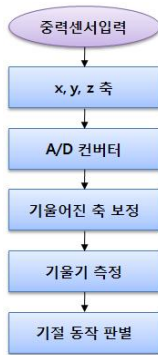
그림 6. 착용형 중력센서를 이용한 기절동작 판별 Fig 6. Recognition of faint action using the wearable gravity sensor
