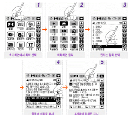
그림 1. 기존의 모바일 번역기의 번역 과정 Fig. 1. Translation Procedure of an Existing Mobile Translator
