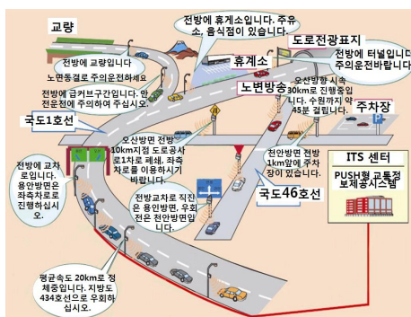
그림 4. 한국형 노변방송시스템 구축 제안 Fig. 4. Design concept of Korea's HAR service on national highway
