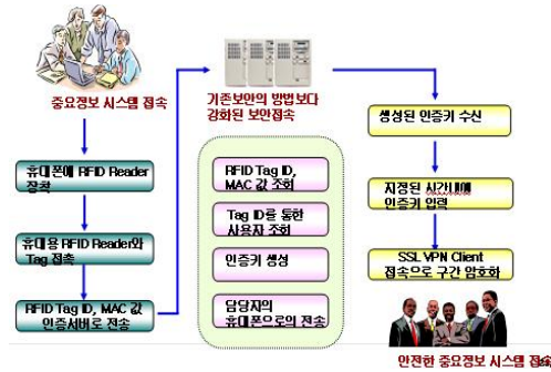
그림 5. 난수 인증키를 통한 접근절차 Fig 5. Process by Random-Number Authentication key
