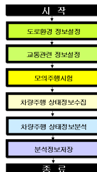
그림 4. 주행 시뮬레이션 절차 Fig. 4. procedure of driving simulation
