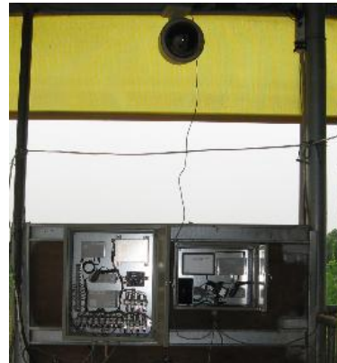
그림 7. 축사에 설치된 웹 카메라, 센서 게이트웨이와 제어 노드의 사진 Fig. 7. Photograph of Web Camera, Sensor Gateway and Control Node in the Stockyard
